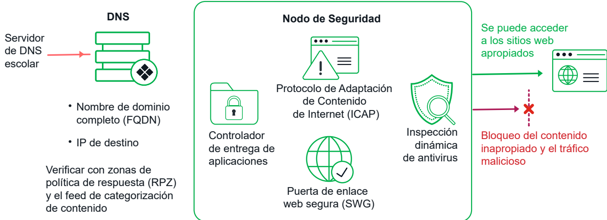
Figura 1: La solución de Infoblox utiliza la categorización e inspección de contenido basada en DNS para mejorar los SWG en el filtrado de contenido.
